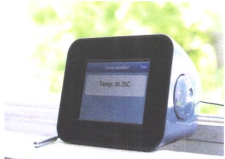
Infocast để chạy trình duyệt và đọc từ cảm biến nhiệt
