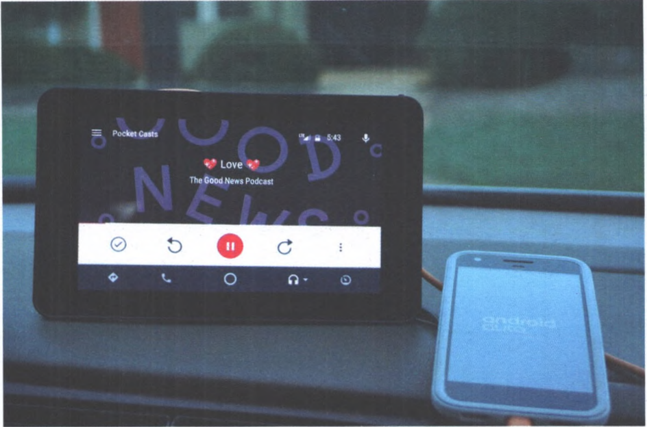
Máy tính Raspberry Pi chạy Crankshaft lắp trong ô tô
