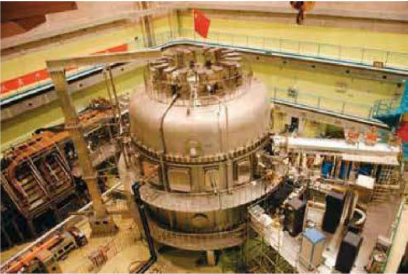
Tokamak - Thiết bị thí nghiệm tạo ra nguồn năng lượng sạch từ tổng hợp hạt nhân nguyên tử việ vật lý plasma thuộc Viện hàn lâm khoa học Trung Quốc nghiên cứu và chế tạo tại Hợp Phi (tên tiếng Anh: EAST, tên thông thường: mặt trời nhân tạo).
